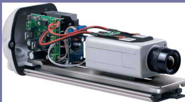
Рис. 14 Термокожух с устройством передачи видеосигнала по кабелю типа «витая пара»
