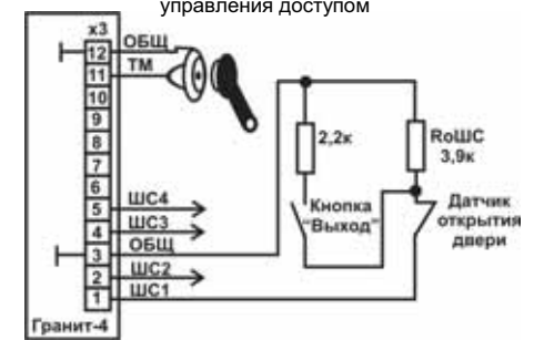
Рис 7. Подключение цепей управления доступом
