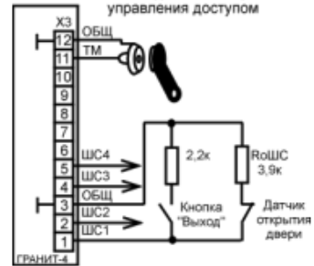
Рис 9. Подключение цепей управления доступом
