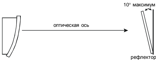
Рис. 2 б. Требования по установке рефлектора
