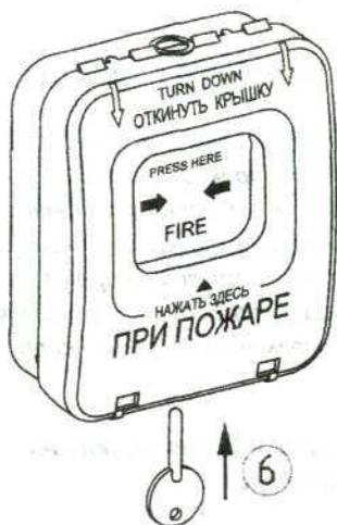
Для приведения извещателя в исходное состояние после срабатывания вставьте толкатель, прилагаемый к извещателю, в отверстие на нижнем торце извещателя и двигайте его вверх (6), до щелчка.
