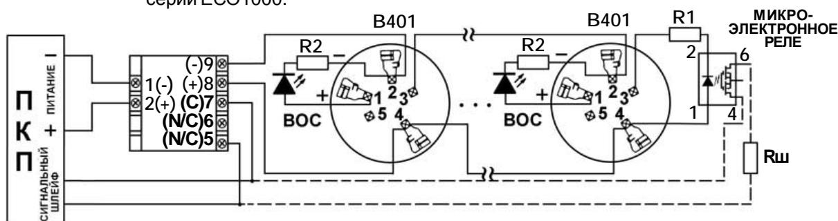
Рис. 2. Схема подключения УС к ПКП и к базам B401 с извещателями 2151E, 5451E.
