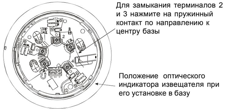
Рис. 1. Расположение терминалов
