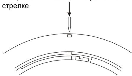
Рис. 3б. Извлечение извещателя из базы после активизации защиты
