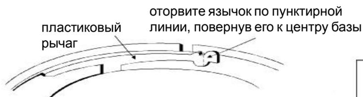
Рис.3а. Активизация функции защиты от несанкционированного извлечения извещателя
